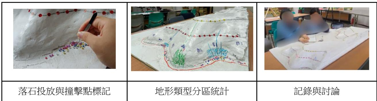
圖 4-5、地形效應導致落石在山稜、山谷、非稜非谷三種路段出現明顯的密度差異。
