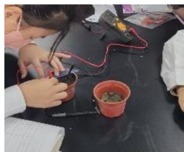
測量土壤的電壓
