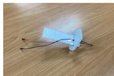
圖四:第二版 Arduino 電路的針腳固定裝置。
