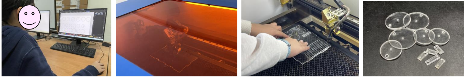
▲圖 1-7：運用學校所學 3D 列印及雷切技術來製作符應我們所需軸心、連動桿和鴨腳等零件尺寸及形狀。
