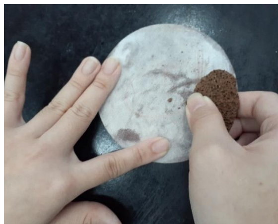
照片 50：用砂紙磨成薄片
