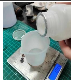
照片 52、54：灌膠至切薄的浮石中
