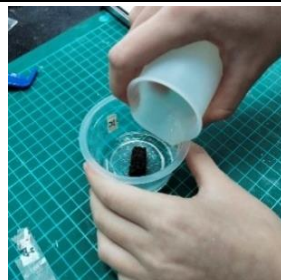
照片 52、54：灌膠至切薄的浮石中
