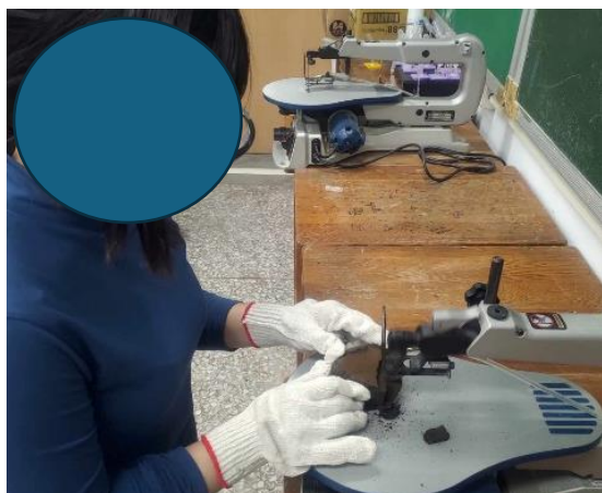
照片 49：用線鋸機切浮石
