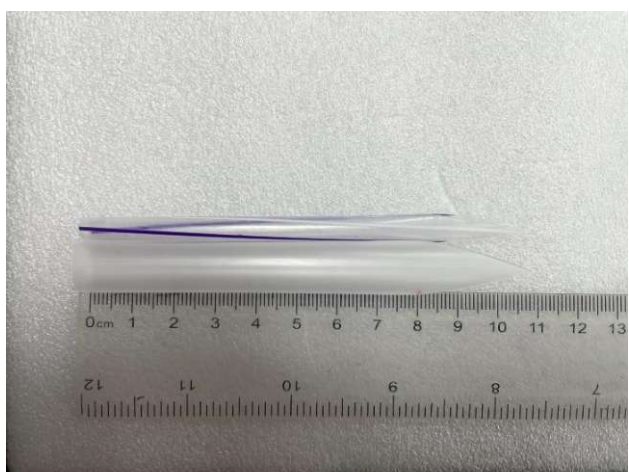
圖十二、吹嘴的部分剪成三角形。
