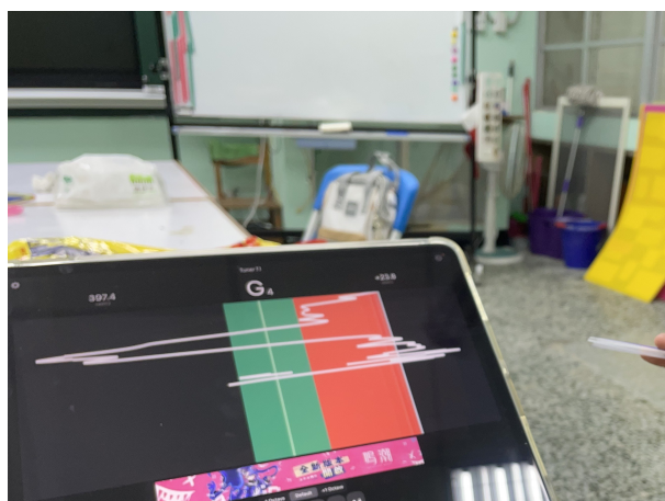
圖八、逐一吹響不同長度的四根吸管，並記錄它的音頻數值。
