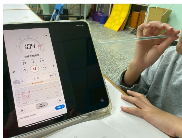
圖十七、逐一吹響不同長度的四根吸管，並記錄它的音頻數值。
