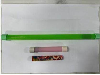
我們將圖中三種長度的魔音管，分別錄下其發出的聲音，因為三種管子都有開放端和密閉端，為了分析兩種滑動方式的聲音有沒有不同，所以我們特別註記了兩種滑動方式的音訊。並用 audacity 軟體分析聲音的音量大小、頻率及音色等，希望可以發現三種長度的魔音管發出的聲音有甚麼不一樣。
