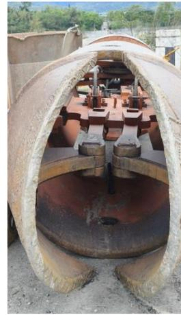
橋樑基礎和樁柱鑽挖機械和工具(崙天大橋)
