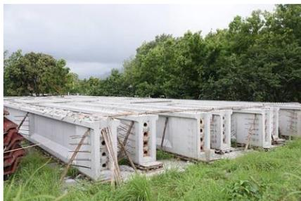
預力混凝土工型樑的預力孔
