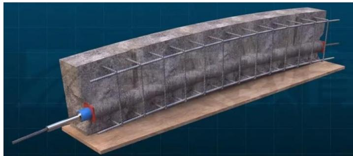
預力混凝土樑預先在兩端以錨具和鋼索加壓
