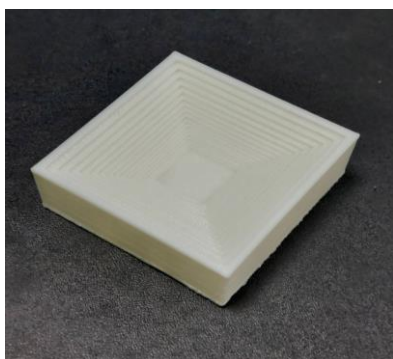
利用 3D 列印機器列印出來 50*50*20 食鹽結晶模型（底面拍攝情形）
