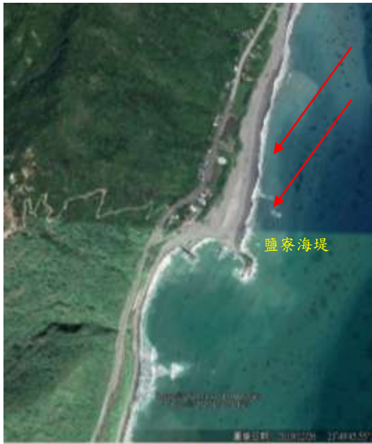
圖 3：鹽寮海堤的人工突堤效應
