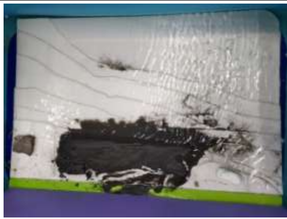
圖 28：放置海砂測試，為增加模型重量， 底下黏鐵板
