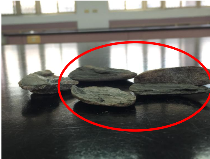
圖 23:片岩加熱後碎裂情形
