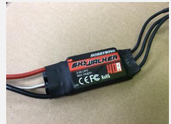
圖 2-5：一端連接高速馬達，另一端連接馬達電子調速器測試儀及鋰電池組，功能是接收馬達電子調速器測試儀的信號，根據此信號調節馬達的轉速，影響撲翅機的翅膀振動速度。
