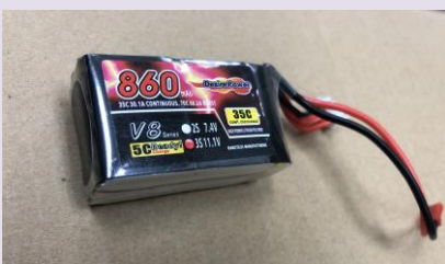
圖 2-6：和電子調速器連接，3S 電池組是代表這塊電池裡有三小個鋰電池，是可快速充電且循環壽命長，在高溫環境下穩定性高的遙控飛機專用之鋰電池組。
