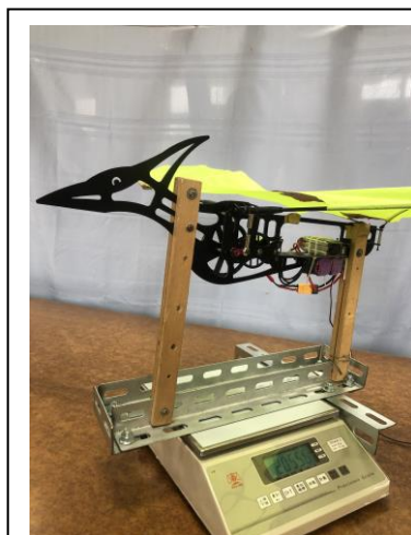
圖 5-1：將撲翅機以木條、螺絲固定於角鐵，再將其立於電子秤上。
