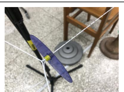
圖 6-9：將「氣流流向測試儀」主體套在畫有尺規刻度的棉繩上。
