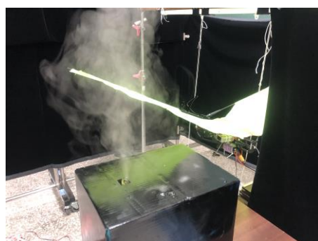
圖 8-1：將自製「煙霧製造機」置於撲翅機「翼尖後方」。
