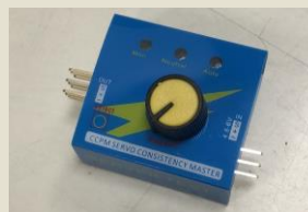
圖 2-7：和電子調速器連接，可擺脫遙控設備進行手動調速。
