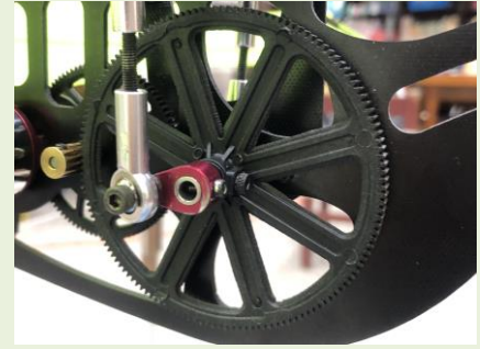
圖 2-3：使用齒輪組合，帶動高速馬達，使撲翅機雙翼可對稱性振動。
