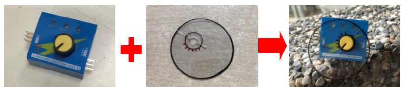
圖 3-2：在「馬達電子調速器測試儀」上套入有做6個等距的不同速度刻度記號的透明圓片。
