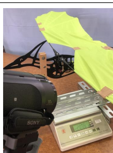
圖 5-2：在器材左前方約 1m 處架設一台攝影機，錄製撲翅機振翅過程中電子秤上數值。
