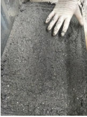
圖十四、實驗準備 3000ml 水以砂土加入直到表層無水光反射視為飽和砂土
