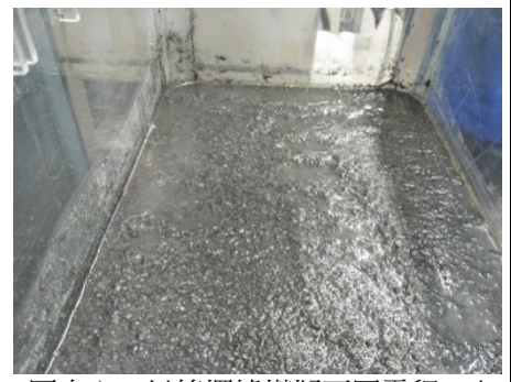
圖十六、以搖擺爐模擬不同震程 gal 值進行搖擺直到表層超過一半以上面積溢出水視為達到土壤液化
