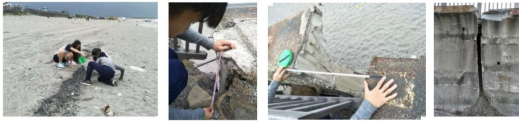
七星潭南側海灘平行海浪衝擊線出現地表破裂面西側壟起約 25 公分，停車場與海灘壟起同側亦出現約 30 公分之抬升，防坡堤上震後受壟起作用垂直出現 60 公分寬之縫隙
