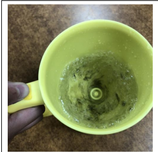
圖 1-3：用攪拌杯攪拌米和水，以取代用手洗米可能造成人為誤差。
