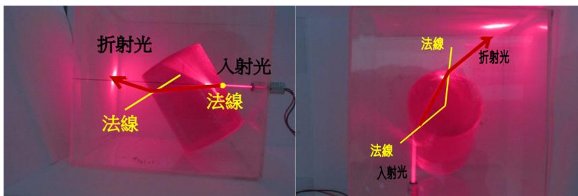
圖 38：光通過壓克力棒，偏折在不同位置的行進方向和法線關係。
