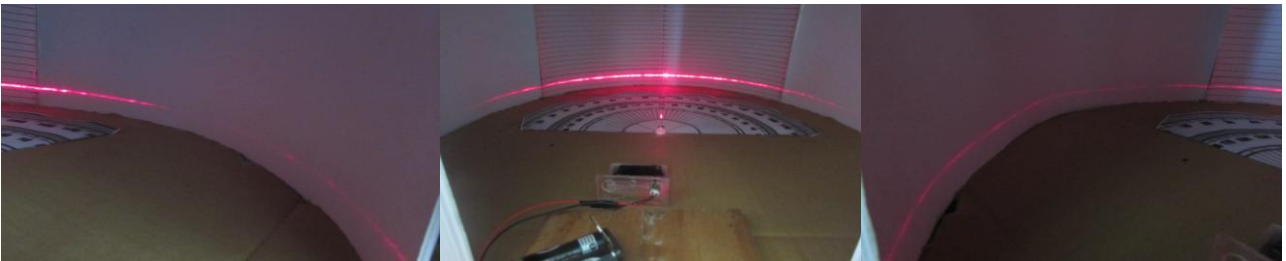
圖 29：光成環形，三張圖皆為同一根玻璃棒。近中央處光比較亮，是折射造成；兩側光比較弱，是反射造成。
