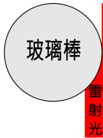
圖 32：雷射光照射玻璃棒邊緣，漏出些微的光，使得照到玻璃雷射光小於原本的寬度。
