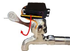
MG996R 外掛在水龍頭上 藉由舵機的轉動角度去關緊水龍頭
